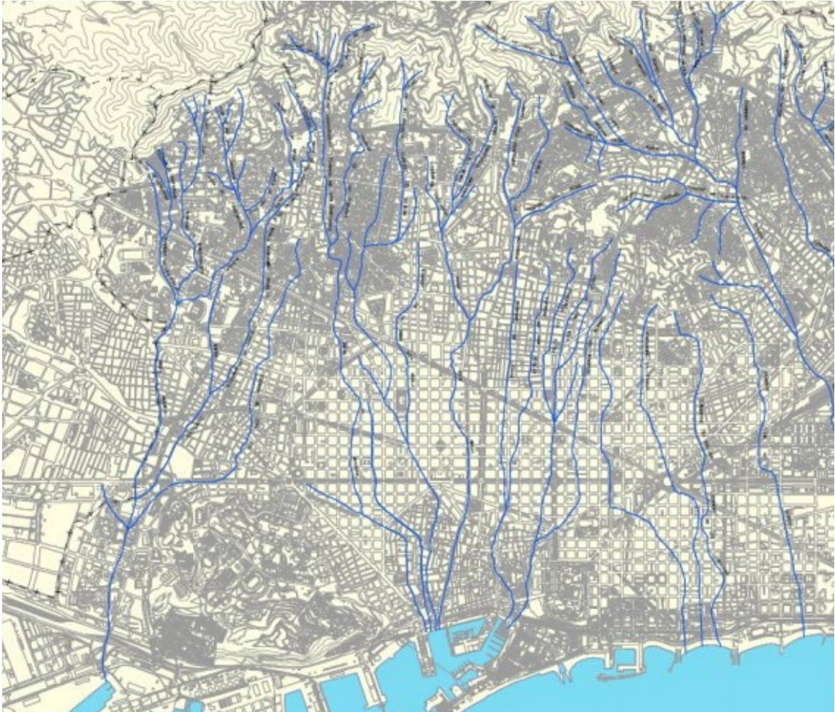
Traçage des anciens torrents et ruisseaux d'eau de Barcelone superposé à la maille de la ville. Source : BCasa
