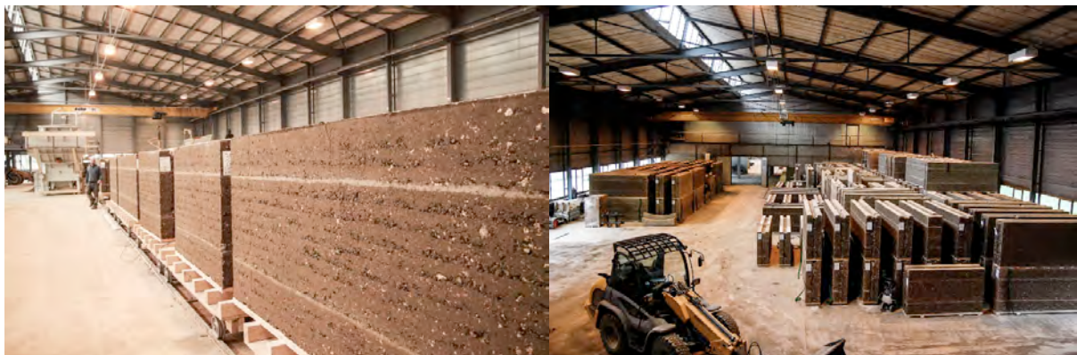
Halle de préfabrication du pisé et stockage © Daniel Lüthi
