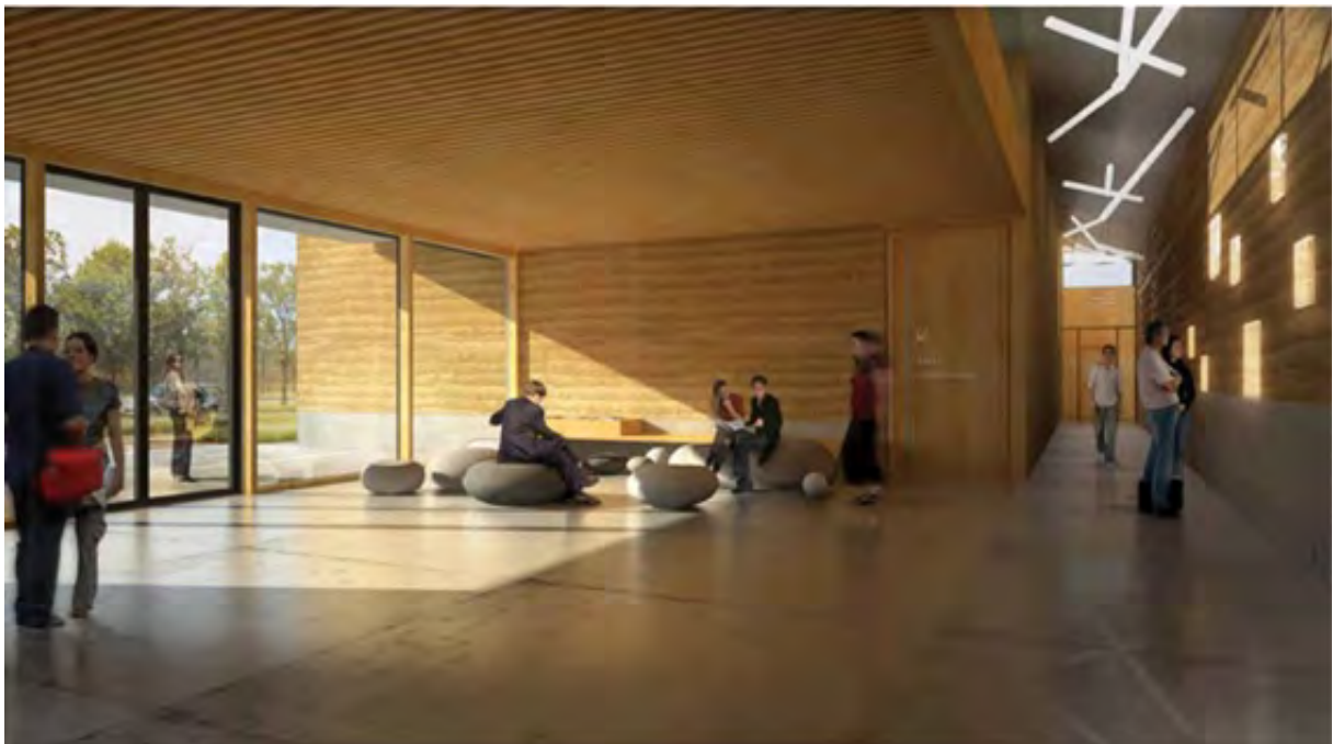
Lumière naturelle à l'intérieur des murs en pisé. La différence de hauteur entre les volumes permet de former des éclairages naturels sur les murs pisés du stockage qui mettent en scènes leurs couleurs et leurs textures qui vibrent tout au long de la journée. © CEES
