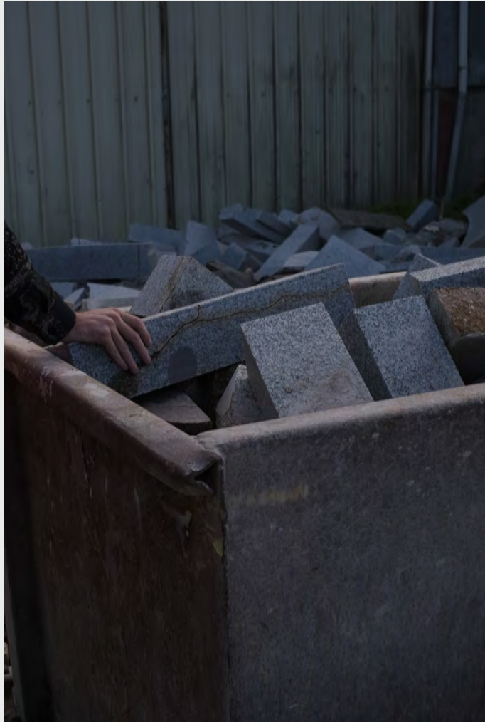
Benne de rebuts issus de l'usinage des pavés, Carrière de Rault-Granit. Photo d'Anna Saint-Pierre
