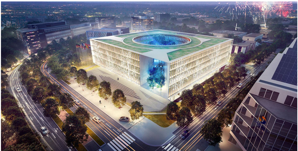
Fig. 3-6. Le Centre International de Recherche sur le Cancer (CIRC) a été conçu en s'inspirant de la cellule biologique représentée par le cercle de la cour intérieure du bâtiment. Une partie de l'enveloppe est faite de verres dotés de lames thermochromiques s'adaptant aux changements de la luminosité extérieure. La cour intérieure est habillée de façades biomimétiques qui augmentent l'efficacité énergétique du bâtiment avec la solution Pho'liage ® qui protège les façades en récupérant de la chaleur. Architecture par ArtBuild et Unanime
